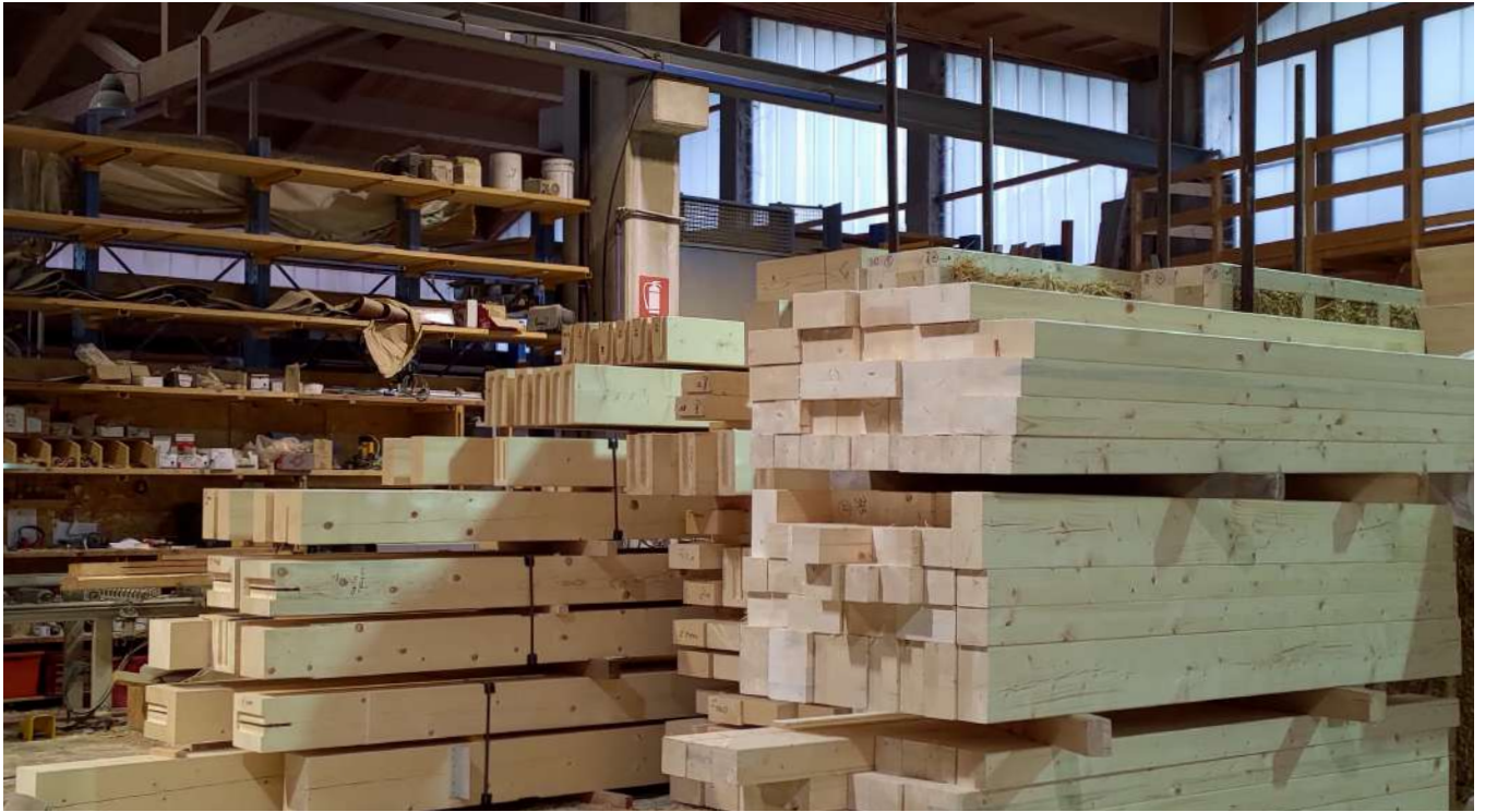
Tutti i pezzi di legno che costituiranno la struttura a telaio sono pronti per il montaggio
