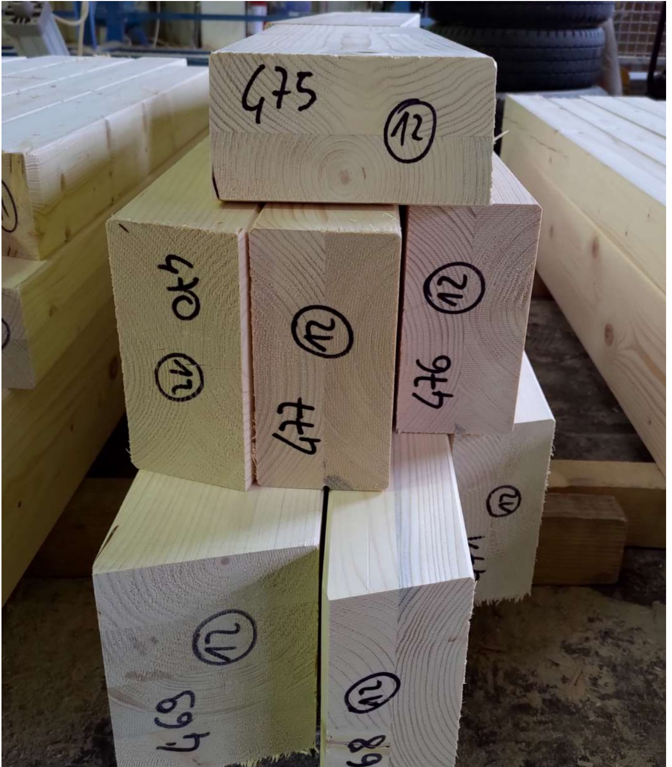
Ogni pezzo di legno è progettato, tagliato e numerato, prima di essere assemblato in un telaio
