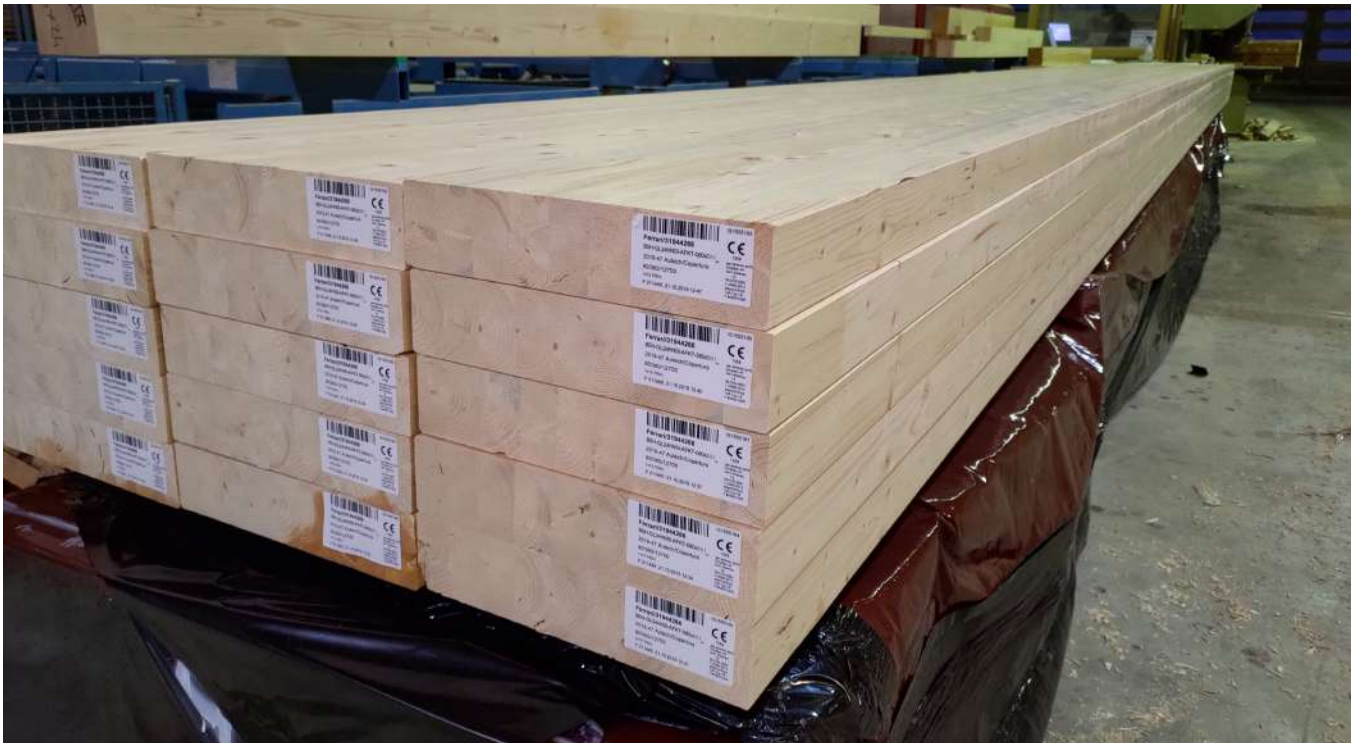
Le travi in legno lamellare che serviranno per costruire la struttura dei pannelli del tetto
